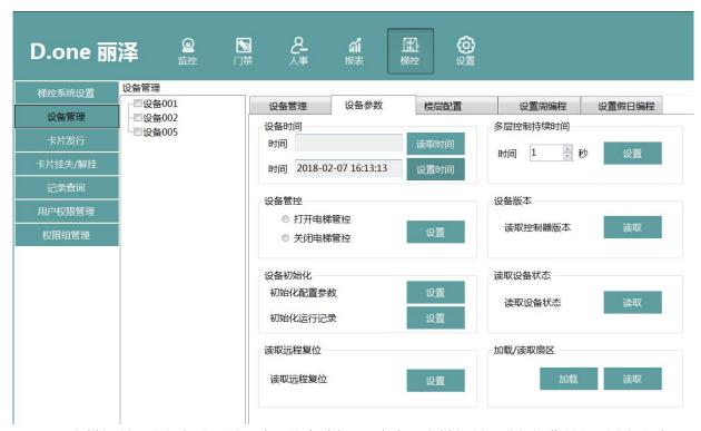
对电梯控制器进行各种设置及读取信息功能。用户在对电梯控制器进行操作前必须选择设备列表下所要操作的电梯控制器。
